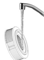
4.1 Rincez avec de l'eau de l'intérieur vers l'extérieur. N'essorer pas le filtre et n'utilisez pas de détergents pour nettoyer.;
