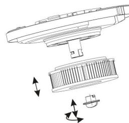
10. Si la puissance est encore insuffisante après le nettoyage du filtre HEPA, démontez le filtre et nettoyez le avec de l'eau. Redémarrer l'aspirateur qu'au moment que le filtre HEPA est complètement sec.
