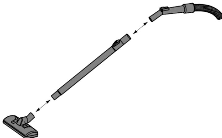
3. Insérez l'autre bout du flexible dans la bouche d'aspiration de l'aspirateur et tournez-la vers la droite un peu pour le verrouiller. Pour enlever le tuyau, tournez vers la gauche et tirez.
